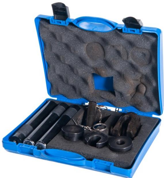
L'extractomètre est un outil de contrôle pour vérifier la résistance en traction des chevilles.
